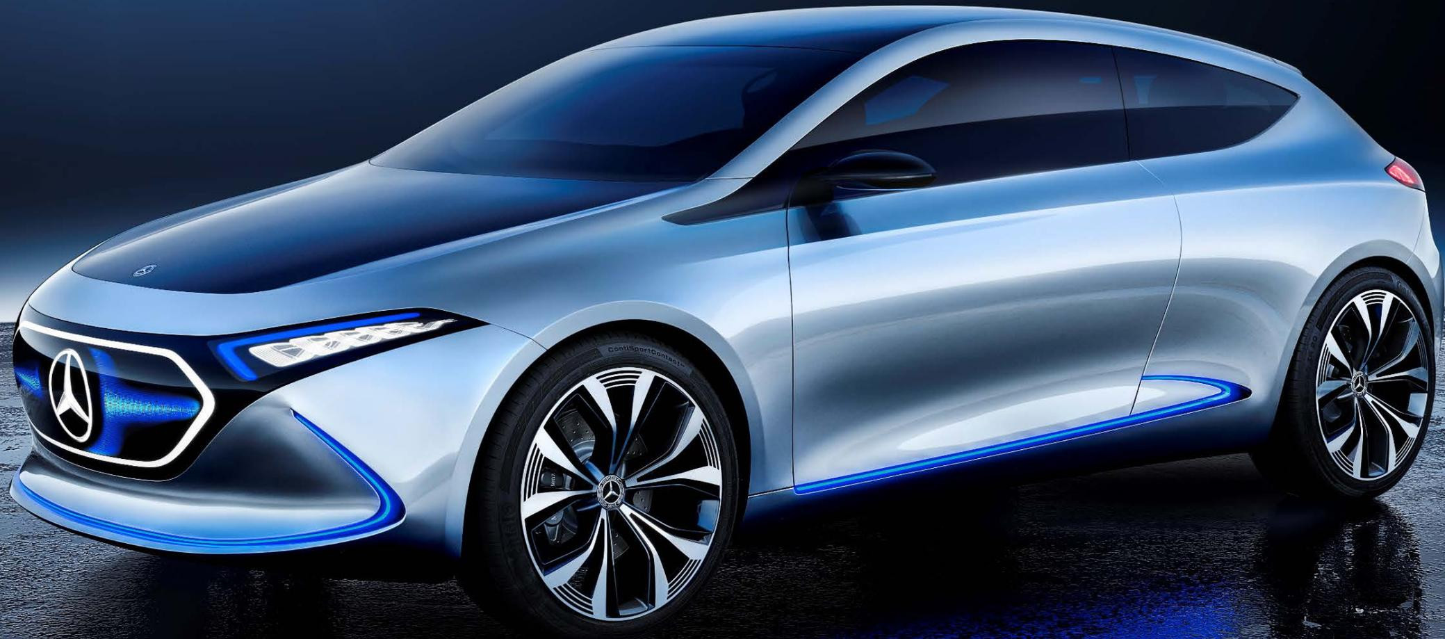
Nuovo “electro look”, con una tecnologia d'illuminazione che impiega il laser a fibre ottiche. La superficie Black Panel del frontale funge da griglia virtuale che cambia il suo aspetto in funzione del programma di marcia selezionato
